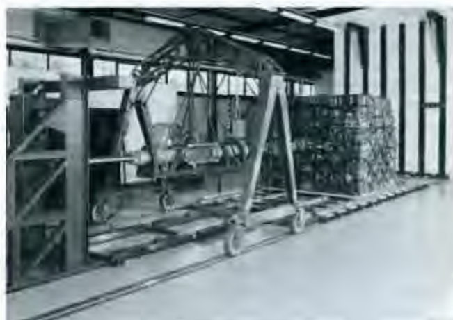
Test d'une palette d'aérotransport pour avion cargo
