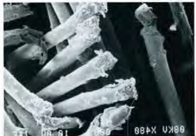
Vue au microscope électronique d'une déchirure sur voile de parachute TAP 661-12
