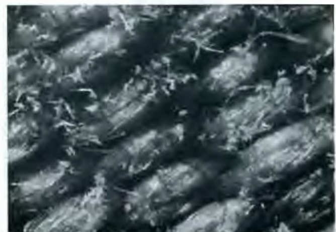
Expertise sur sangle d'ouverture automatique, détérioration due à des frottements rapides.
